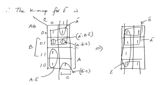
$$F = \overline{A} + \overline{B} + \overline{c} \Rightarrow F = (A \cdot B \cdot c)$$
